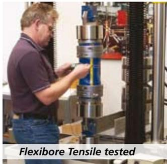
Flexibore Tensile tested
